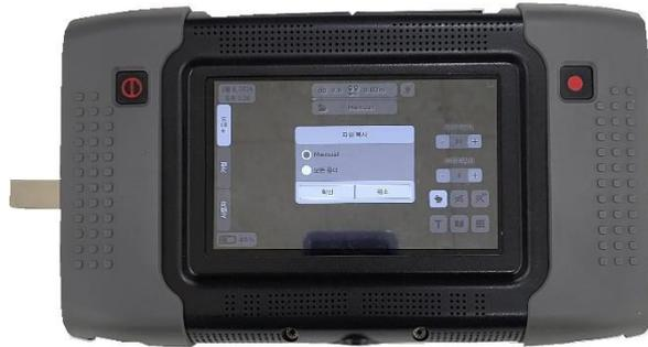
*USB 를 연결하여 데이터를 추출 중인 BATCAM 2 의 모습*
