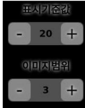
디스플레이에 나타나는 빔파워는 설정한 표시기준값보다 소음의 크기가 크거나 같아야 표시됩니다. 반대로 설정된 표시기준값보다 소음의 크기가 작을 시 빔파워가 표시되지 않으며, 정확한 소음 측정을 위해 측정 환경에 따라 표시기준값 설정을 확인하는 것이 좋습니다. 표시기준값은 측정하려는 소음의 특성과 측정 환경에 따라 최소 0 dB부터 120 dB까지 설정할 수 있습니다.
