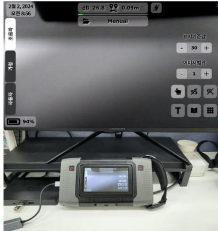
BATCAM 2 와 모니터를 HDMI 케이블로 연결하여 위 사진과 같이 BATCAM 2 화면이 모니터로 출력되도록 할 수 있습니다.
