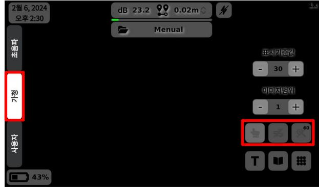
※ 디스플레이 좌측 측정 모드에서 가정모드 선택 시 누설량 측정과 부분방전 측정 등 상세 측정 모드 아이콘들이 비활성화 됩니다.
