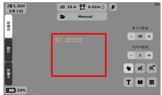
사진을 저장할 때 좌측 하단에 미리보기가 몇 초간 표시됩니다. 이 때 미리보기 아이콘을 눌러 바로 사진을 확인하고 메모를 작성할 수 있습니다. 사진 내의 측정 시간, 주파수 조건, 빔형성파워 최대값 등의 정보가 포함됩니다.
