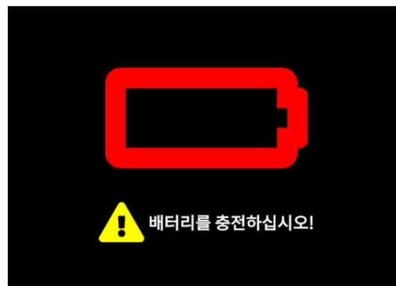
위 경고 메시지가 나타났을 때, 전원을 끄거나 전원 어댑터를 연결하여 즉시 충전을 할 수 있습니다. 전원 어댑터를 연결한 후 배터리가 2% 이상이 되면 아래 그림처럼 주황색의 배터리 표시로 바뀌며, 15% 이상 충전되면 다시 BATCAM 2를 사용할 수 있습니다. 또는 전원을 껐다 다시 켤 경우, 제품을 다시 사용할 수 있습니다.
