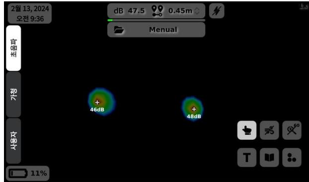
최대 3개 소음원의 빔파워를 동시에 디스플레이에 표시합니다. 각 소음원의 크기(dB)는 빔파워 위치에 같이 표시되며, 다수의 소음원을 측정할 때 유용합니다.
