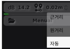
자동 옵션을 선택하면, 제품 전면에 부착된 거리 센서로 감지된 물체와 BATCAM 2의 거리를 즉각적으로 확인할 수 있습니다.
